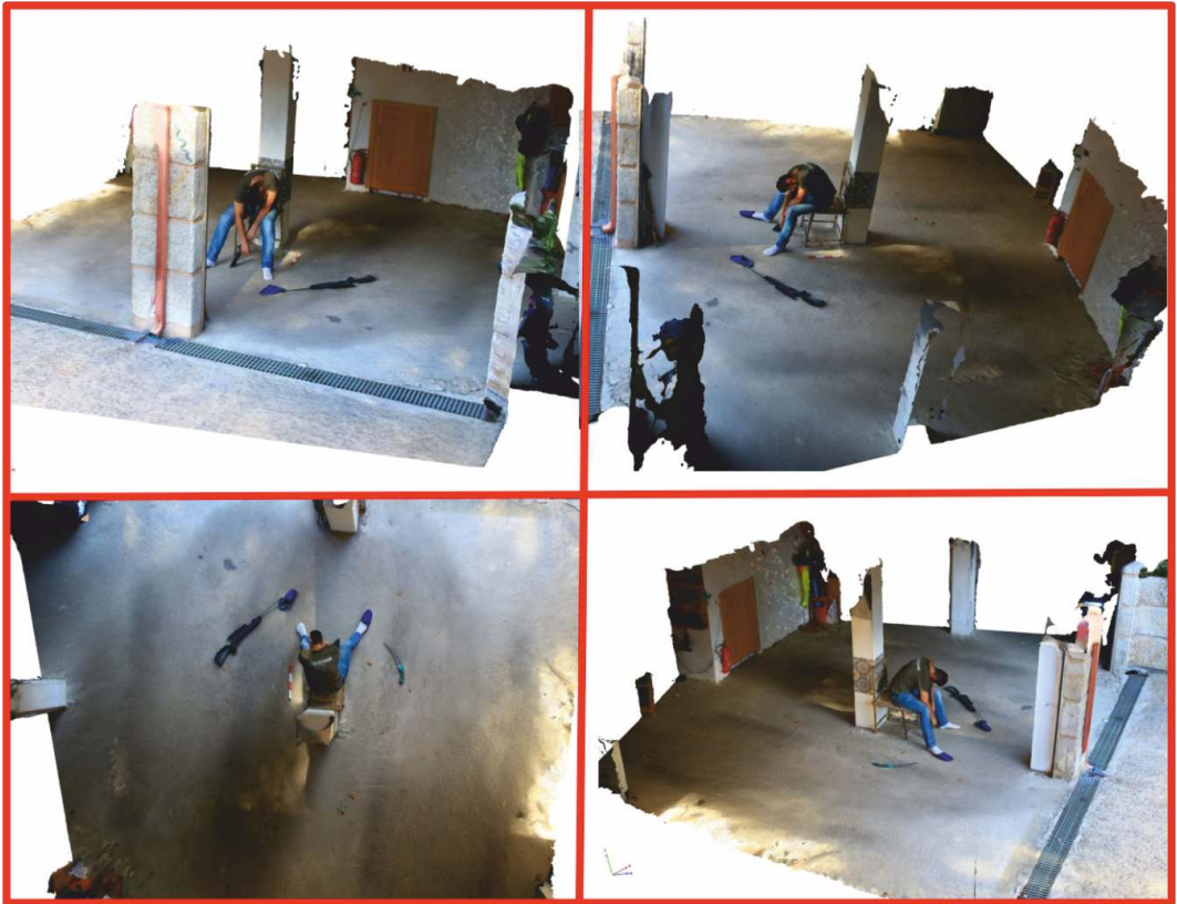
FOTOGRAFÍA 2: Adquisición mediante fotogrametría de una escena de crimen simulada. Procesado mediante el programa Agisoft. El programa genera un pdf 3D en el que es posible mover las imágenes en los 3 ejes. En la imagen vemos algunas capturas de pantalla de éste pdf.
