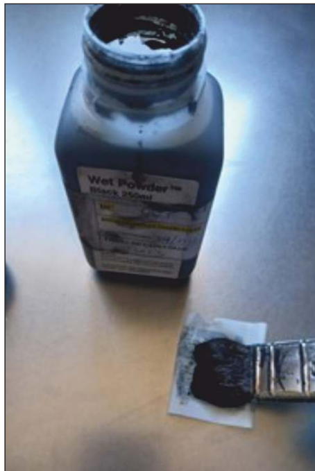
Fotografía nº 16. Aplicación de Net Power, óptimo para la cara mordiente de las cintas adhesivas.
