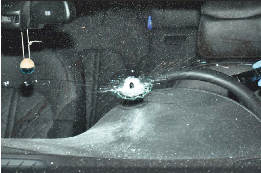
Fotografía nº 2. Orificios perforante (con entrada y salida). Formación de estrías radiales.
