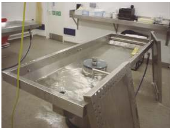
Fotografía 5. Mesa de autopsia y sistema de aspiración de aire
